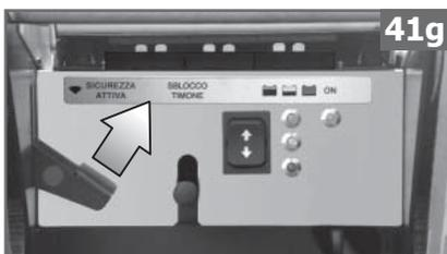
Отсоедините руль, подняв ногой рычаг безопасности "L", и затем рычаг отсоединения "S"
