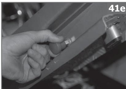
Потяните ручку соединения во внешнюю сторону для отсоединения ската.
