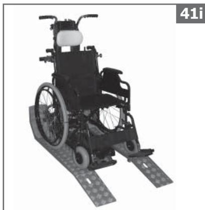
Поместите коляску, так, чтобы она встала на рампы до упора колес в задней части самих рампы. (P)
