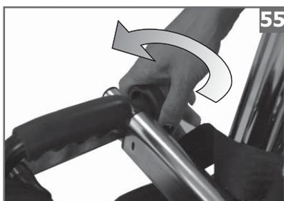
Затяните зажимы кронштейнов, при помощи ручек для закручивания "V".
